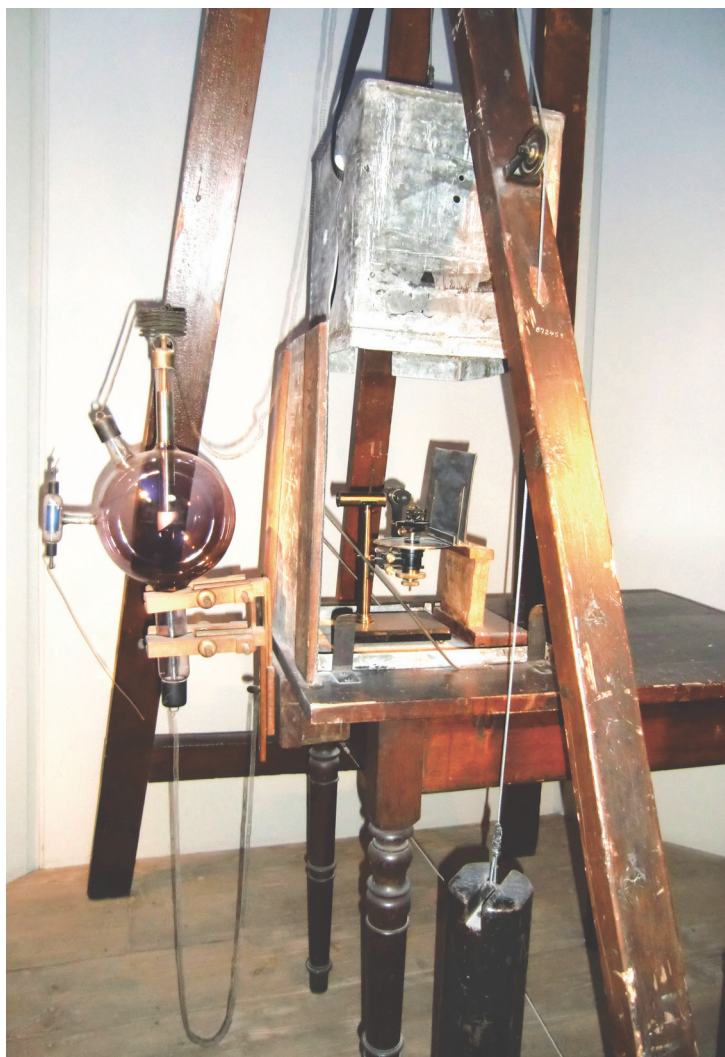
Ryc. 1. „Aparatura Lauego” użyta w pierwszych doświadczeniach Waltera Friedricha i Paula Knippinga demonstrujących dyfrakcję promieni X na kryształach, będąca zasadniczo rekonstrukcją z wykorzystaniem oryginalnych elementów. Muzeum Niemieckie, Monachium (fot. M. Eckert)
